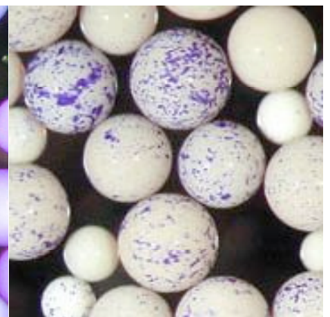
Oberfläche nur noch punktuell gefärbt: sehr starkes Fouling
